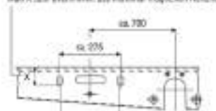
Aufnahmebohrungen für Ersatzradhalter
