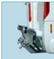
Fahrzeug mit hochgeklapptem Träger ca. 40 cm kürzer
