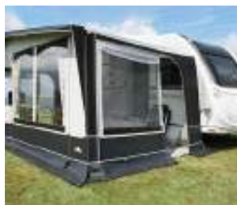
Herausnehmbare Seitenwände mit Eingangstür
