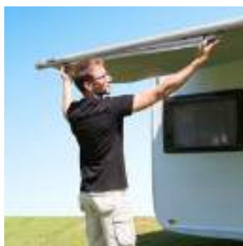
1 Das gleichzeitige Ausschwenken der Stützfüße und Spannarme
