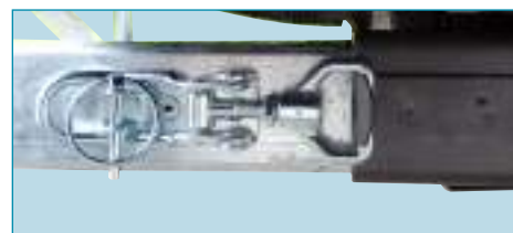
Tragrohre mit Schnellverschluss
