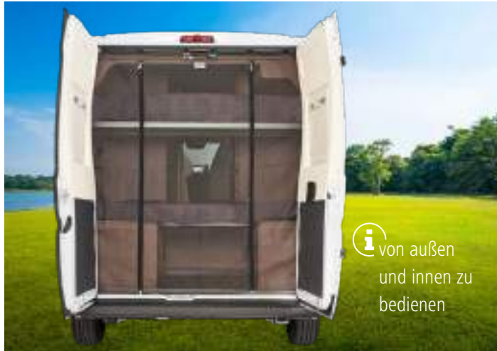
Dreiseitig perfekt dichter Abschluss mit Magnetbefestigung
